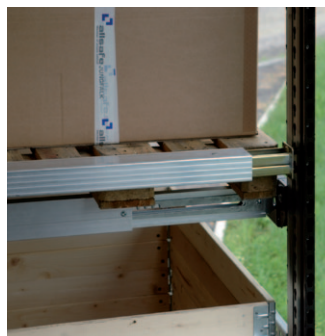
Zabezpieczenie systemu podwójnej podłogi CTD III belką blokującą AJJS KAT
